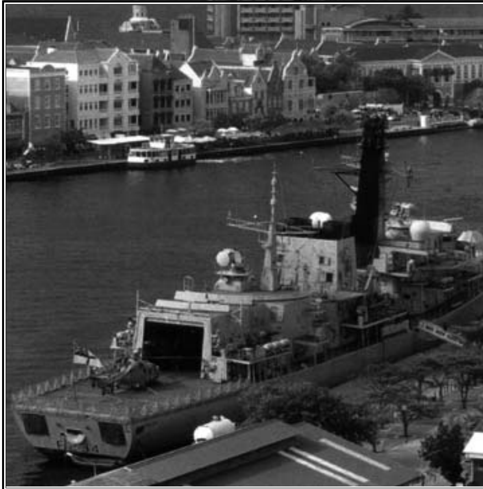
Las fragatas Tipo 23, aunque equipadas con el sistema misiles antiaéreos Sea Wolf VL y los misiles antibuques Harpoon , son sobresalientes unidades ASW . Asimismo, con sus helicópteros Merlin , denominados la fragata desde el aire, constituyen un formidable equipo ASW . De todas maneras, el espacio en la cubierta de vuelo es un tema prioritario y salvo que el mar se encuentre calmo, el aterrizaje no es fácil. Estas unidades especiales tienen un costo elevado y por ello, después del fin de la Guerra Fría, numerosas armadas relegaron esta capacidad.
